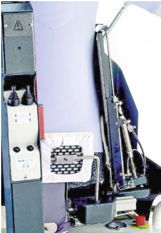
Система SideDry натягивает и высушивает боковые швы. В базовой комплектации на Trevistar CR3 и на TreviTandem
